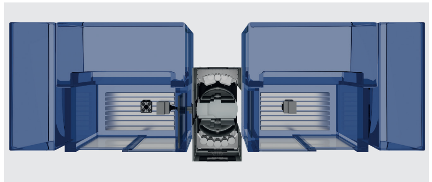
EROWA Robot Compact 80 "Twin" gestisce due macchine.
