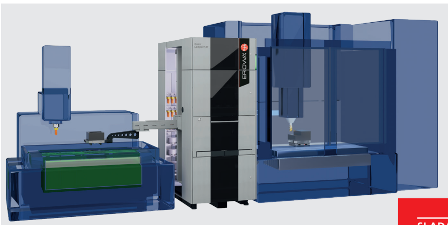
EROWA Robot Compact 80 tra una macchina per elettroerosione a tuffo e un centro di fresatura.
